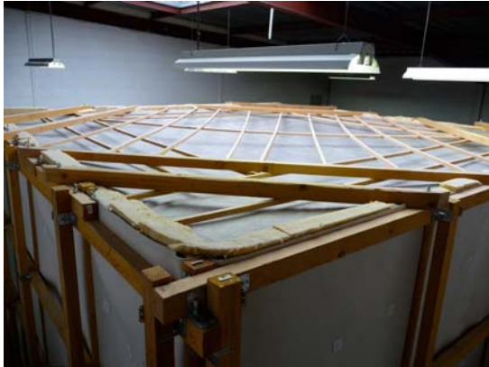
Vue externe du haut de la cabine de mesure de 100 mètres cubes construite au centre de l'atelier. Elle culmine à plus de six mètres. Constituée d'une armature en bois, elle comporte des parois souple laissant passer les ondes néfastes, mais assurant des conditions adaptées aux mesures.
